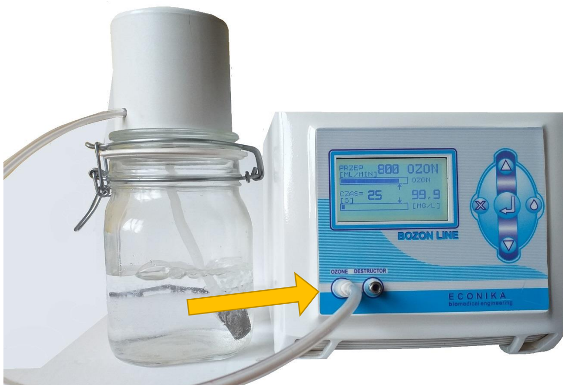
Rys. 10. Podłączanie urządzenia do ozonowania wody destylowanej
