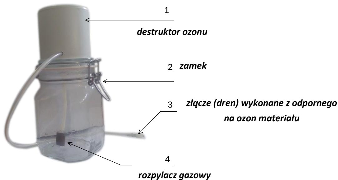
Rys. 8. Urządzenie do nasycania wody ozonem.
